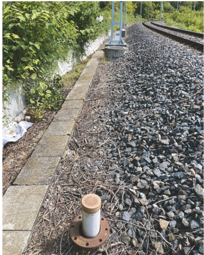
5. ábra – Pálya mellett kialakított inklinométer mérési pontok
