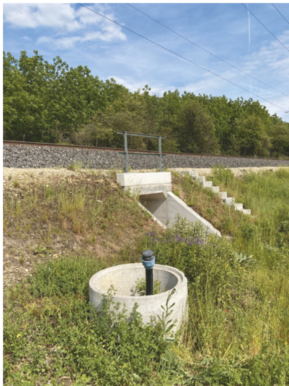
8. ábra – Sülyedésmérő cső kiállása
