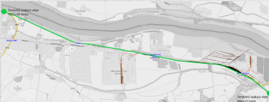
Almásfüzitő – Komárom-Rendező szakasz fejlesztése (225 kN, 160 km/h)
