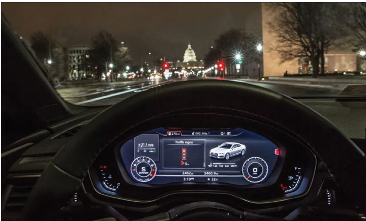
7. ábra: Jelzésekpváltásig hátralévő idő megjelenítése a jármű fedélzeti kijelzőjén (forrás: https://eu.azcentral.com/story/news/local/mesa-traffic/2018/12/04/mesa-adds-new-road-technology-audi-drivers-emergency-vehicles-traffic-signals/2152095002/ )
