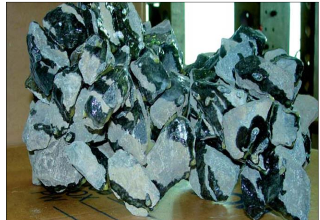
Összeragasztott ágyazati szemcsék
