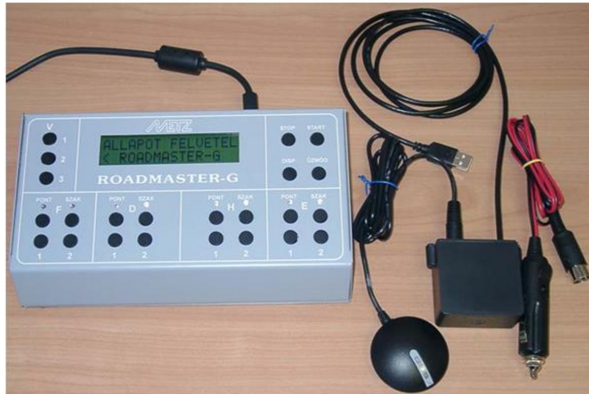
F1.1. ábra – Roadmaster-G terepi adatfelvevő készülék
