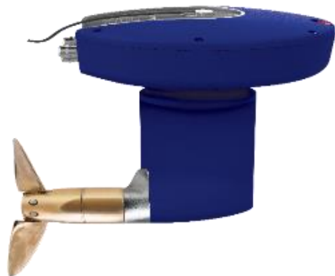
15 tonnás kishajókhöz SD 15 típusú 15 kW /48 V BLDC motoros 1140 ford/perc hajócsavar (46,5 kg tömegű)
