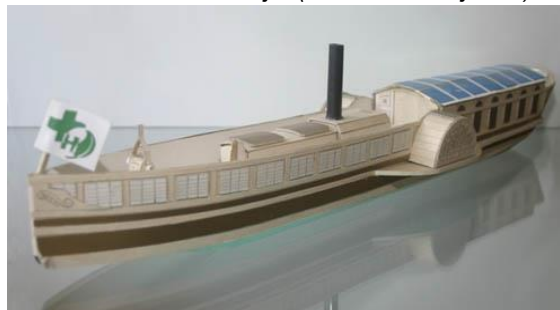
4./ 15 tonna alatti Széchenyi hungarikum múzeumhajó (napelemes) 18 m hosszú, 3,6 m széles, 0,45 m merülés
