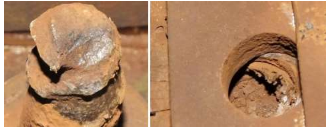
Csavar törési felület és kitört csavar helye [17]
