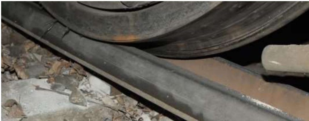
A siklott jármű kereke az oldalára borult sínszálon [17]
