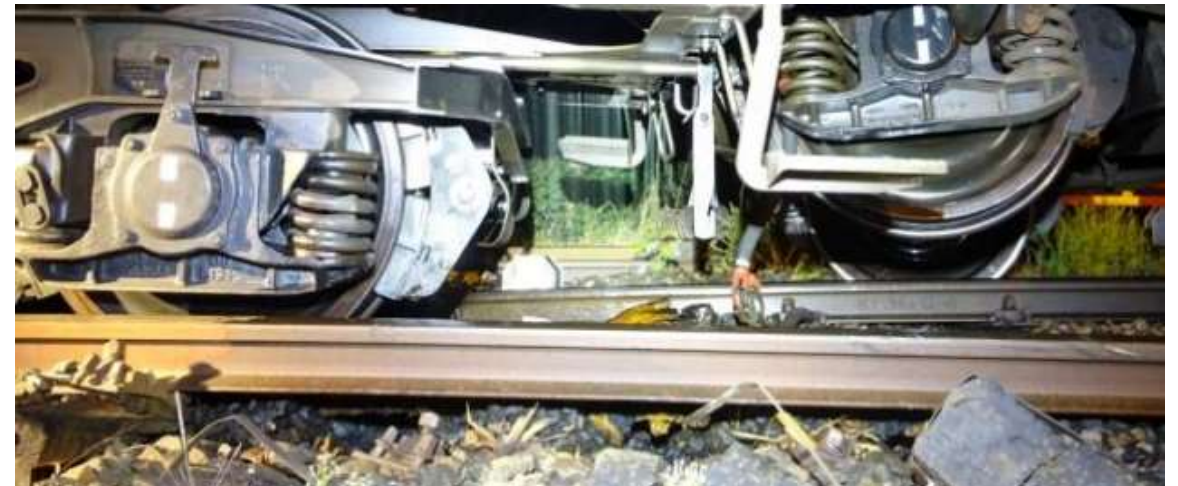
Siklást követő gázolaj szivárgás [30]
