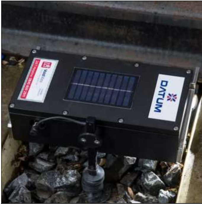
VoidMate Track Void Monitor [39] Függőleges elmozdulás mérése
