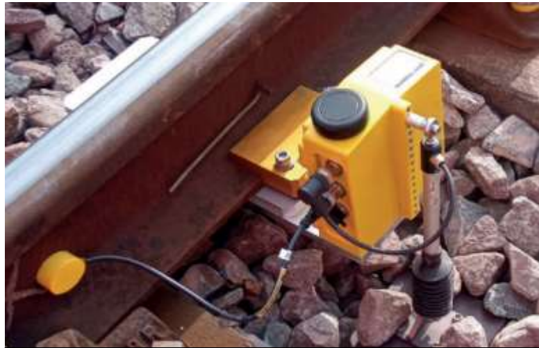
RailSense VoidSense (RTVMD) [40] Függőleges elmozdulás mérése Sínhőmérséklet mérése
