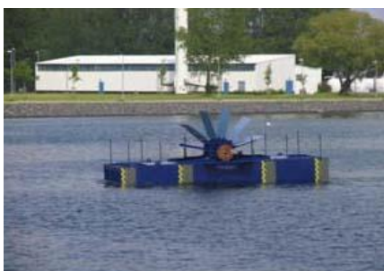
1 m széles acél hajómalom lapátkerék
