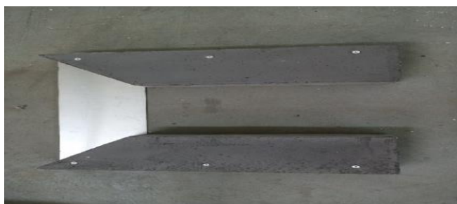
4 m * 14 m EPS beton katamarán hajómalom alap
