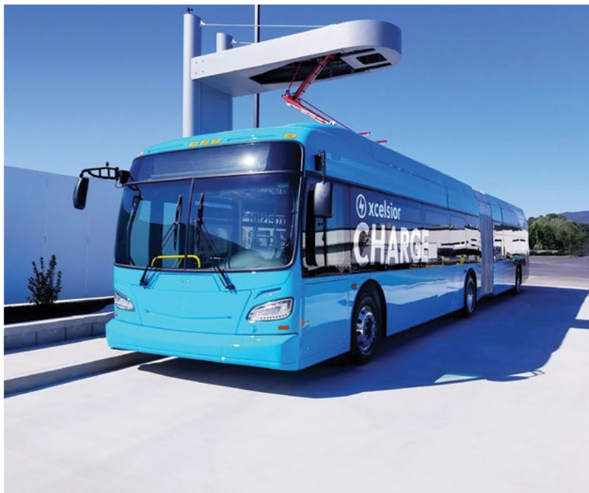
5. ábra – Elektromos autóbusz töltése automatizált pantográfal (forrás: [12])
